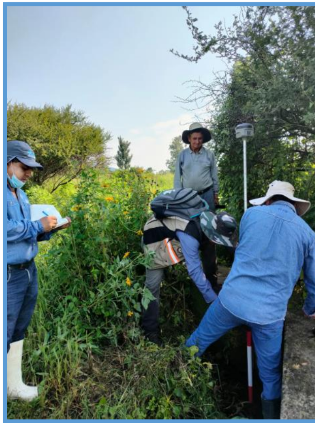
Imagen 9 Levantamiento topográfico con RTK comunidad Guerra Huayco
